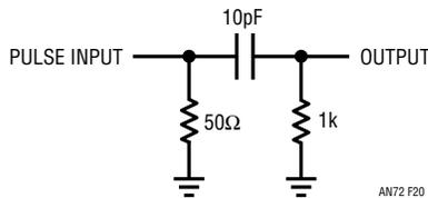
**Figure 20. Probe Test Circuit**
